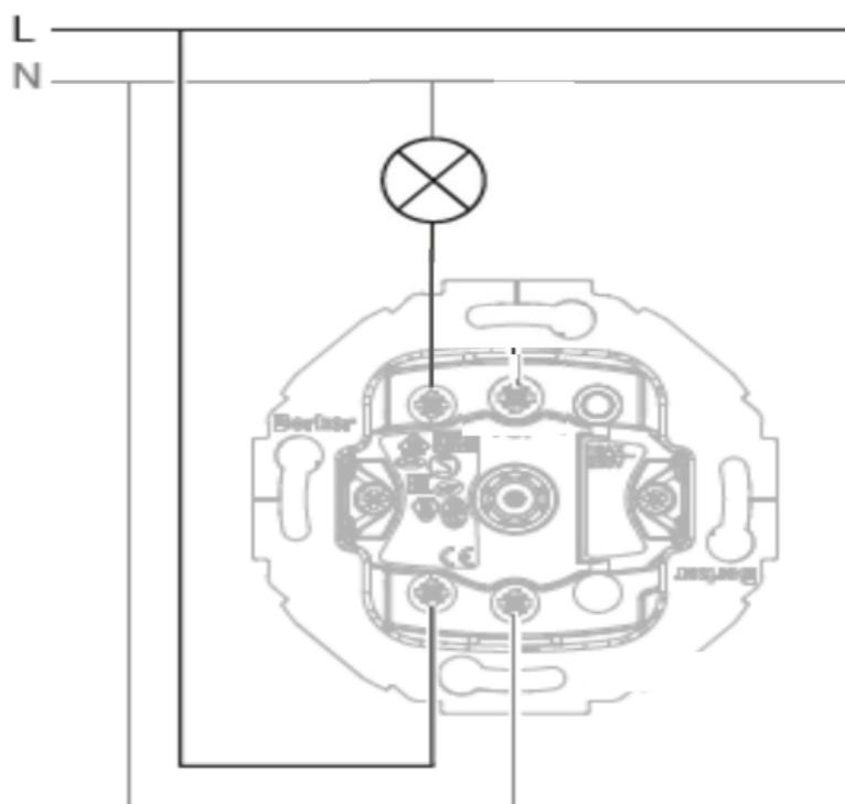
*Pour une utilisation avec interrupteur en signalisation, il est conseillé de câbler le neutre avec de l'éclairage à led.*
